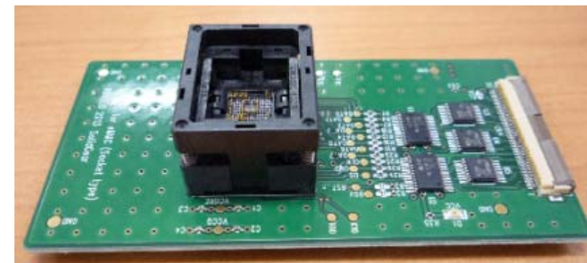
[Socket type Mini POD for eMMC (HS200)]
