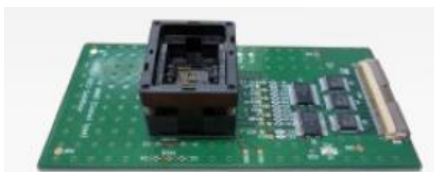
Mini POD for eMMC socket type (HS200)
